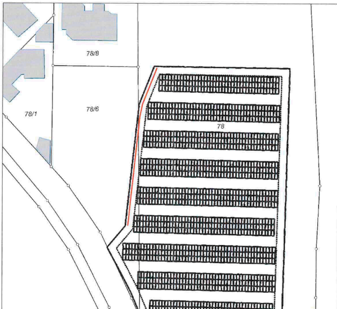
Abbildung 9: Lageplan mit Darstellung der zu errichtenden Blendschutzmaßnahme
